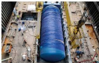
船体に設置されるLNG。このほか低硫黄燃料、ガスオイル燃料の計3種類の燃料に対応したデュアル・フューエル・エンジンを搭載
